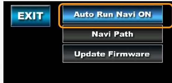
Si consiglia ,durante il periodo di prova, di lasciare le impostazioni del computer impostato su RUN OFF AUTO NAVI. Se questa opzione è ON, il sistema si avvia automaticamente ogni volta. Per selezionare l'applicazione di navigazione predefinito che si desidera eseguire, fare clic sul percorso opzione NAVI. Per modificare il percorso del file. EXE. la navigazione fare clic sul pulsante con i quattro punti[....]. La corretta directory e' comunque:
